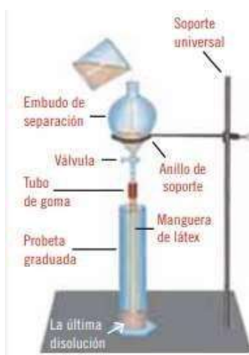
Figura 9. Si no cuentan con un embudo que tenga llave, pueden usar una botella de plástico con un tapón, una manguera y una pinza para tender la ropa.
